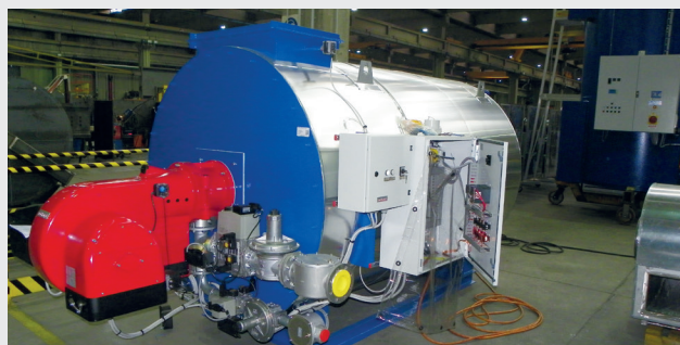
Nagrzewnica gazowa GASAIRBLOC gotowa do załadunku
