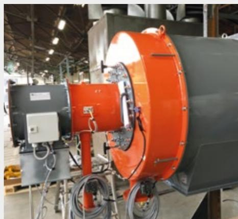
**Rango de potencia:** De 7 a 22 MW
