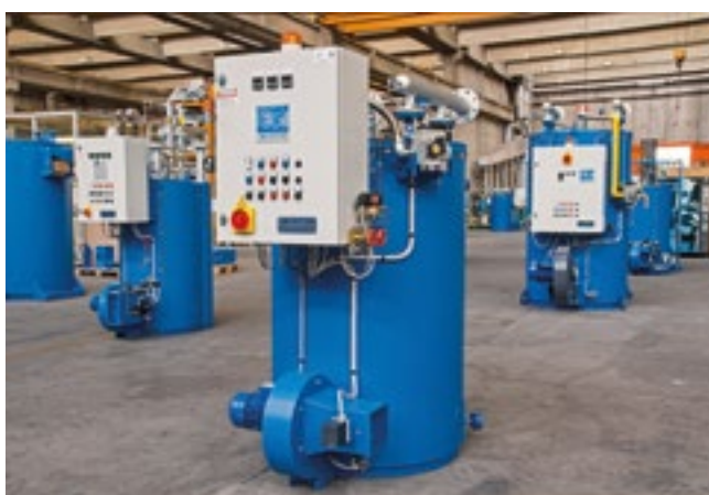
Várias unidades (TPC) em construção
